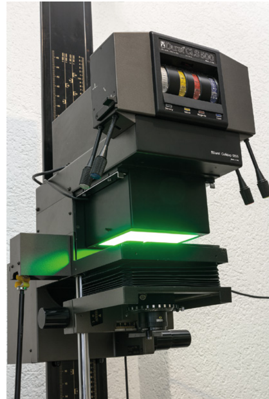
Abbildung 1.7: Vergrößerer mit eingebauter Heiland-LED-Lichtquelle
